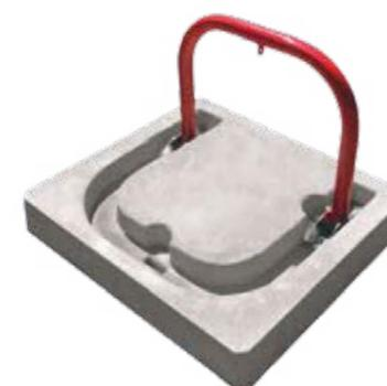
Dissuasore parcheggio con elemento sollevabile in metallo base realizzata con metodo a getto in conglomerato cementizio 425, con impronta per elemento in metallo, affinché resti al livello del manufatto. Il dissuasore può essere alzato e bloccato in posizione retta per non permettere l'accesso delle auto.
