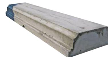
Basamento inferiore per balaustra, elemento gettato in conglomerato cementizio 425, di forma trapezoidale è la parte di sostegno inferiore della balaustra, ai quali si ancorano i colonnini, con decorazioni che si allargano per raggiungere l'attacco a terra. Da inserire su tutta la lunghezza al di sotto dei colonnini per garantirne l'ancoraggio e una stabilità statica.
