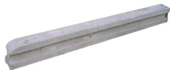
Pilastro per cancellata a fiocco, elemento gettato in conglomerato cementizio 425, pilastro con doppia scalanatura per incastro e sostegno della cancellata a fiocco, da ancorare al suolo. Si consiglia fissaggio accurato.
