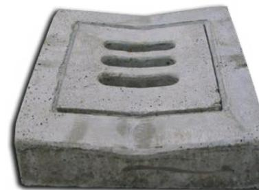
Lapide in cemento a doppia pendenza con foro per tappo rettangolare e tappo elaborato a griglia, elemento vibrato in conglomerato cementizio 425, chiusino versatile per interrompere zanelle a pendenza e permettere il deflusso nel pozzetto delle acque piovane.
