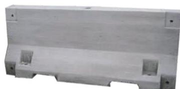
New Jersey standard, barriera divisoria e antisfondamento, elemento gettato in conglomerato cementizio 425, in forma trapezoidale in un'altezza di 80 cm per garantire un'ottima stabilità presenta un foro superiore per inserimento di pali, due maniglie passanti al di sotto del manufatto per la movimentazione con macchine, due fori per parte per fissaggio a terra e quattro fori per collegamento con altri elementi.
