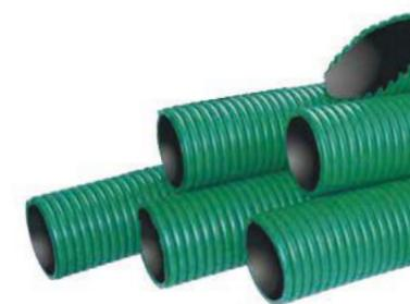
Tubo corrugato per drenaggio con marcatura CE, a doppia parete in HDPE di colore verde esternamente e nero internamente, conforme alla normativa CEI EN 61386-24 (ex CEI EN 50086-2-4/A1-CEI 23-46; V1)
