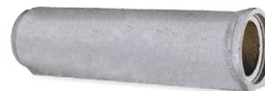
Tubo cemento portante, vibro-compresso in conglomerato cementizio 425, di forma circolare base piana per una distribuzione omogenea del carico, lunghezza di 200 cm, rinforzato, con innesto per giunzione.
