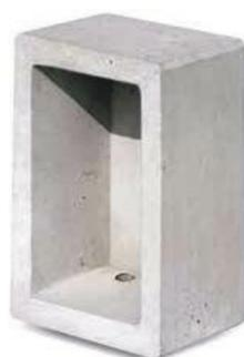
Porta contatore ENEL, presenza di impronte per il passaggio dei tubi o dei cavi con fori di Ø40 e Ø60, possibilità di incasso a muro o appoggio a terra, elemento gettato in conglomerato cementizio 425, dimensioni variabili in relazione alla necessità di installazione, disponibile in due misure uno piccolo e uno grande, quello piccolo presenta due fori, quello grande ne ha quattro simmetrici, entrambi delle dimensioni soprariportate.
