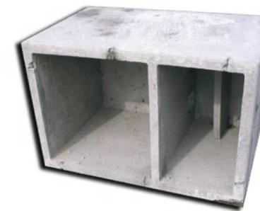
Pozzetto degrassatore rettangolare, elemento vibrato in conglomerato cementizio 425, da utilizzare per il trattamento delle sole acque saponate delle cucine e dei bagni. Il numero delle persone servite può variare a seconda delle disposizioni di ogni comune.
