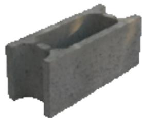
Blocco cassero da costruzione, elemento vibrocompresso idrofugato in conglomerato cementizio 425, facile posa in opera, possibilità di armatura orizzontale e verticale, da finire con intonaco.
