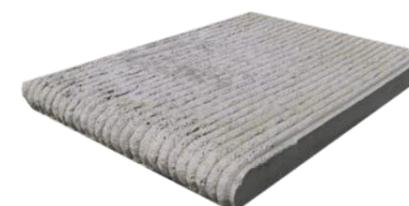
Scalino da esterno rifinito in effetto finta pietra, elemento gettato in conglomerato cementizio 425, la classicità toscana elaborata in uno scalino, bello, ricercato, funzionale, adattabile a qualsiasi dimensione. La rigatura a finta pietra è duratura nel tempo, ruvida e permette un facile deflusso delle acque per evitare fenomeni di scivolamento.
