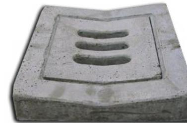
Lapide in cemento a doppia pendenza con foro per tappo rettangolare e tappo chiuso elaborato a griglia, elemento vibrato in conglomerato cementizio 425, chiusino versatile per interrompere zanelle a pendenza e permettere il deflusso nel pozzetto delle acque piovane.
