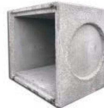
Prolunga per pozzetto spessorato con quattro impronte per il passaggio di tubi incastro superiore per prolunga o lapide, elemento vibrato in conglomerato cementizio 425, impilabile su pozzetti e prolunghe.
