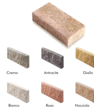
Mattone normale facciavista disponibile nelle varie colorazioni, elemento vibrocompresso idrofugato in conglomerato cementizio 425, ripropone la decorazione e la finitura del cemento in un elemento facciavista, non ha bisogno di essere intonacato.
