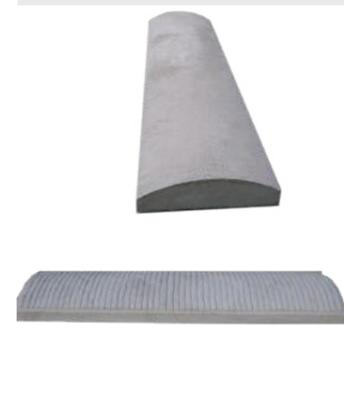
Copertina semplice a bauletto con unica curvatura superiore, elemento gettato in conglomerato cementizio 425, semplice e bello per una copertina universale per qualsiasi muro.
