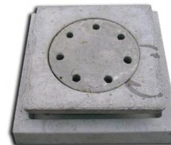
Lapide in cemento sifonata con tappo forato circolarmente, elemento vibrato in conglomerato cementizio 425, chiusino che permette il deflusso nel pozzetto delle acque piovane.
