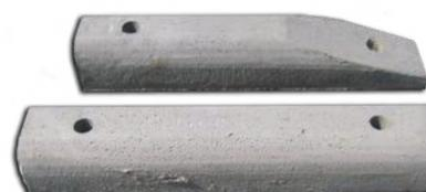
Cordolo a profilo rettangolare con doppia stondatura superiore e due fori passanti per garantirne il fissaggio sul manto stradale, vibrato con conglomerato cementizio 425. Trova il suo più comune utilizzo come definizione della pista ciclabile, composto di due elementi uno modulare dritto e l'altro utilizzato all'inizio e alla fine.
