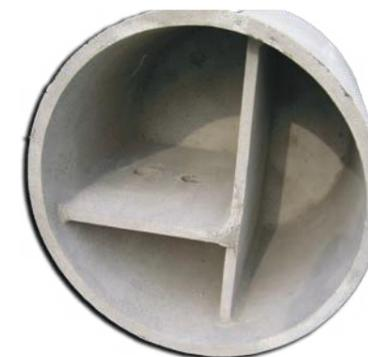
Pozzetto diseolatore circolare, elemento vibrato in conglomerato cementizio 425, la vasca dei diseolatori è divisa in tre settori: due hanno funzione di disoleazione primaria (decantazione dei fanghi pesanti) e secondaria (installato un filtro a coalescenza), collegati idraulicamente tra di loro, mentre il terzo settore ha funzione specifica di raccolta e stoccaggio degli oli minerali (ed idrocarburi), risulta stagno e indipendente dagli altri e permette la raccolta degli oli con autobotti.
