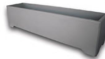
Fioriera pari industriale con piedini, elemento gettato in conglomerato cementizio 425, la fioriera in cemento presenta una finitura liscia, la parte superiore piana e quattro piedini ai bordi permettono il distacco da terra per facilitare la movimentazione, ampia capacità, possibilità di forarla per fuoriuscita di acqua in eccesso.
