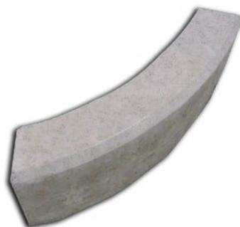
Cordolo semplice rettangolare curvo, vibrato con conglomerato cementizio 425, spigolo esterno rifilato per una maggiore decorazione, utilizzabile per realizzare raggi di curvatura stretti o per la realizzazione di elementi curvi.
