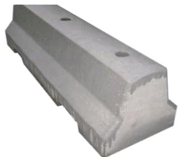
New Jersey mini, barriera divisoria e antisfondamento, elemento gettato in conglomerato cementizio 425, in forma trapezoidale in un'altezza di 51cm per garantire un'ottima stabilità presenta tre fori superiori per inserimento di pali, due maniglie passanti al di sotto del manufatto per la movimentazione con macchine.
