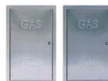
Porta contatore GAS abitazione doppio, presenza di tre impronte laterali passanti per il passaggio dei tubi o dei cavi con fori di Ø80, possibilità di incasso a muro o appoggio a terra, elemento gettato in conglomerato cementizio 425. Porta in lamiera zincata o Acciaio Inox con scritta GAS punzonata specchiata e alloggiamento inserimento chiave idonea.
