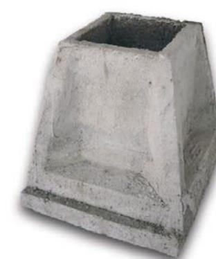
Plinto prefabbricato per pilastro, elemento vibrato in conglomerato cementizio 425, presenta foro per l'inserimento del pilastro verticale, il plinto è di forma trapezoidale da sistemare a terra, riceve e scarica a terra le forze che riceve dalla struttura.
