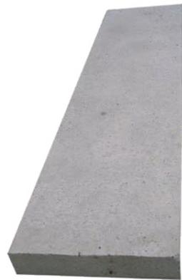
Zanella pari per deflusso delle acque, elemento vibrato in conglomerato cementizio 425, di forma rettangolare, buona portata di acqua grazie alla sua superficie liscia, facile da installare viene solitamente montata a ridosso di un cordolo o della pavimentazione. Consigliata stuccatura dei giunti, e intervallato il montaggio con pozzetti per la raccolta delle acque.
