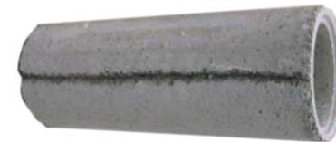
Tubo cemento, elemento vibro-compresso in conglomerato cementizio 425, di forma circolare per una distribuzione omogenea del carico, con incisione longitudinale per permettere una facile rottura e incastro per innesto con altro tubo, facilità di installazione. Prodotto per il passaggio sotterraneo di acque piovane o divisione per realizzare due canale.
