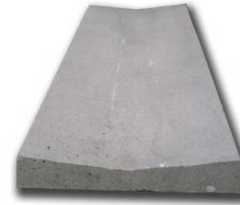
Zanella con doppia pendenza per il deflusso delle acque, elemento vibrato in conglomerato cementizio 425, di forma trapezoidale, buona portata di acqua grazie alla sua superficie liscia, facile da installare viene solitamente montata a ridosso di un cordolo o della pavimentazione. La doppia pendenza agevola la canalizzazione delle acque piovane, la quale scorre centralmente alla zanella. Consigliata stuccatura dei giunti, e intervallato con pozzetti per la raccolta delle acque.
