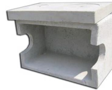
Pozzetto tipo FIRENZE, elemento vibrato in conglomerato cementizio 425, il pozzetto è composito in base alle esigenze, si compone del basamento con scanalatura a mezzaluna, le eventuali pronghe e il coperchio con i relativi tappi da ispezione.
