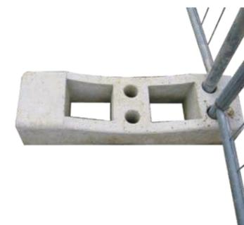
Plinto per recinzione da cantiere, elemento vibrato in conglomerato cementizio 425, composto di quattro fori circolari per inserimento dei pilastri della recinzione, due fori quadrati da alleggerimento con la possibilità di un migliore ancoraggio se interrato e una zavorra laterale che svolge la funzione di contrafforte.
