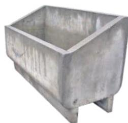
Fioriera inclinata da incasso, elemento gettato in conglomerato cementizio 425, la fioriera in cemento presenta una finitura liscia, la parte superiore piana e due correnti longitudinali che permettono l'ancoraggio sulla muratura, ampia capacità, possibilità di forarla per fuoriuscita di acqua in eccesso.
