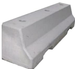
New Jersey mini laterale, barriera divisoria e antisfondamento, elemento gettato in conglomerato cementizio 425, in forma trapezoidale e un lato dritto con angolo retto in un'altezza di 45 cm per garantire un'ottima stabilità presenta due fori superiori per inserimento di pali, due maniglie passanti al di sotto del manufatto per la movimentazione con macchine.
