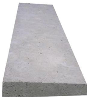
Zanella con una pendenza per il deflusso delle acque, elemento vibrato in conglomerato cementizio 425, di forma trapezoidale, buona portata di acqua grazie alla sua superficie liscia, facile da installare viene solitamente montata a ridosso di un cordolo o della pavimentazione. La pendenza agevola la canalizzazione delle acque piovane, utilizzando il cordolo come altro battente. Consigliata stuccatura dei giunti, e intervallato il montaggio con pozzetti per la raccolta delle acque.
