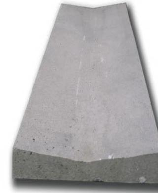
Zanella con doppia pendenza carrabile per il deflusso delle acque, elemento vibrato in conglomerato cementizio 425, di forma trapezoidale, buona portata di acqua grazie alla sua superficie liscia, facile da installare viene solitamente montata a ridosso di un cordolo o della pavimentazione. La doppia pendenza agevola la canalizzazione delle acque piovane, scorrendo centralmente alla zanella. Consigliata stuccatura dei giunti.
