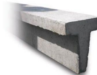
Trave strutturale a T, elemento vibrato in conglomerato cementizio 425, classica forma a T per la distribuzione dei carichi. Molto utilizzato per sorreggere le coperture di capannoni industriali.
