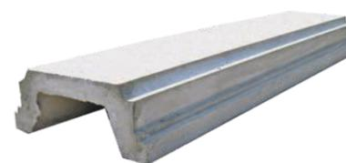
Basamento superiore per balaustra, elemento gettato in conglomerato cementizio 425, di forma trapezoidale è la parte di sostegno superiore della balaustra, ai quali si ancorano i colonnini, con decorazioni che si allargano per raggiungere la dimensione del corrimano. Da inserire su tutta la lunghezza al di sopra dei colonnini per garantirne l'ancoraggio e una stabilità statica.
