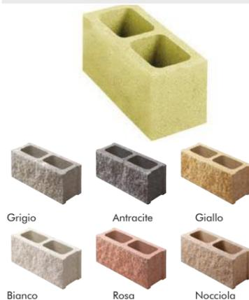
Blocco normale facciavista disponibile nelle varie colorazioni, elemento vibrocompresso idrofugato in conglomerato cementizio 425, ripropone la decorazione e la finitura del cemento in un elemento facciavista, non ha bisogno di essere intonacato.
