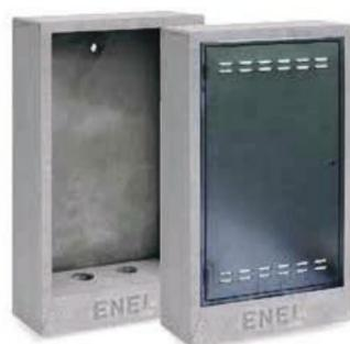
Porta contatore ENEL industriale, presenza di impronte per il passaggio dei tubi o dei cavi con due fori di Ø120, possibilità di incasso a muro o appoggio a terra, elemento gettato in conglomerato cementizio 425, nel basamento è presente l'impronta di riconoscimento ENEL. Porta in lamiera zincata. con forature e alloggiamento inserimento chiave.
