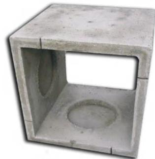
Prolunga per pozzetto standard con quattro impronte per il passaggio di tubi, elemento vibrato in conglomerato cementizio 425, impilabile su pozzetti e prolunghe.
