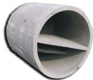
Pozzetto degrassatore circolare, elemento vibrato in conglomerato cementizio 425, da utilizzare per il trattamento delle sole acque saponate delle cucine e dei bagni. Il numero delle persone servite può variare a seconda delle disposizioni di ogni comune.
