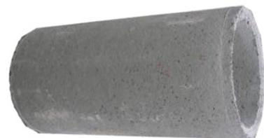
Tubo cemento con fondo, elemento vibro-compresso in conglomerato cementizio 425, di forma circolare per una distribuzione omogenea del carico, con tappo sul fondo.
